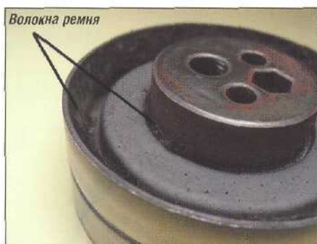
Волокна ремня Попадание волокон ремня во вращающиеся части ролика.
