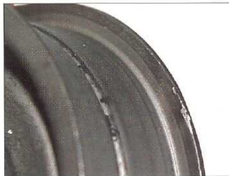
Повреждение боковых направляющих ремня, вызвавших повреждение ремня.
