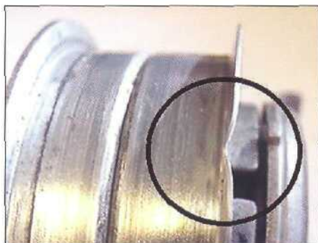
Сильное повреждение фланца шкива.
