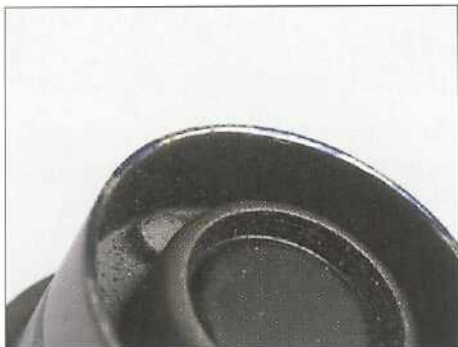
Неправильный монтаж крышки ГРМ.
