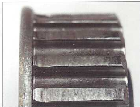
Попадание постороннего предмета в систему ГРМ.
