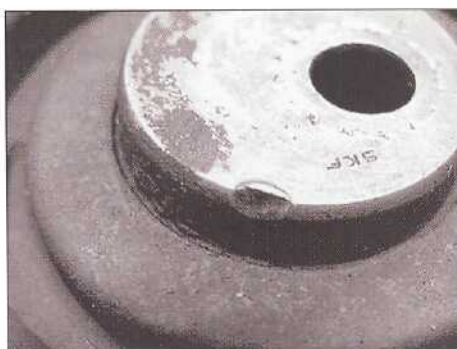
Повреждение от удара вследствие неправильного монтажа.
