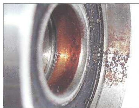
Очаги коррозии. Посторонние частицы попадают в подшипник и являются причиной преждевременного выхода из строя.
