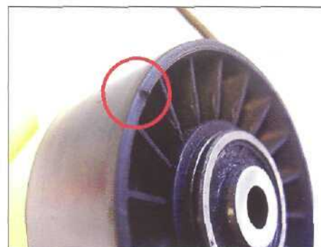
Значительные следы на пластиковом шкиве от удара посторонним предметом.
