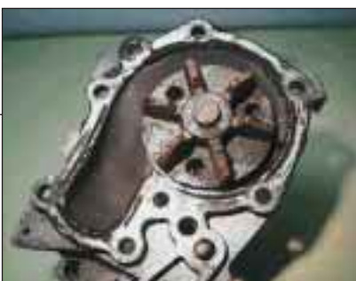
Неподходящий состав охлаждающей жидкости и загрязнение системы
