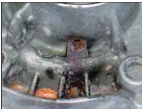
Коррозия и загрязнение из-за плохого качества или старения охлаждающей жидкости
