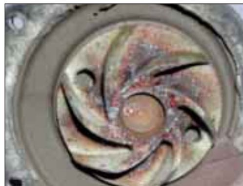
Ухудшение характеристик крыльчатки из-за кавитации (возникновения воздушных пузырьков) в системе охлаждения
