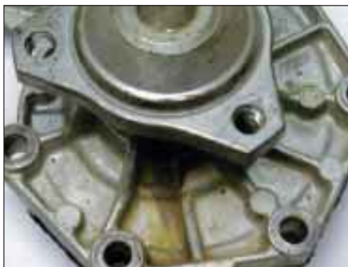
Протечка смазки подшипников вала через вентиляционное отверстие
