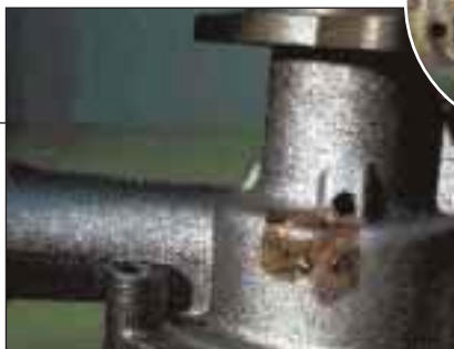
Попадание герметика в систему вследствие его избыточного количества
