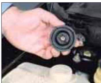
Убедитесь в отсутствии износа крышек
