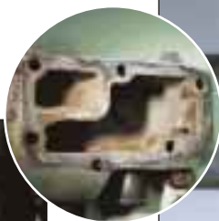
Ржавчина или известковые отложения – отсутствие охлаждающей жидкости
