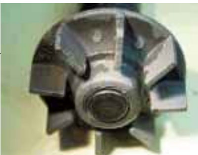
Перегрев с образованием вздутий
