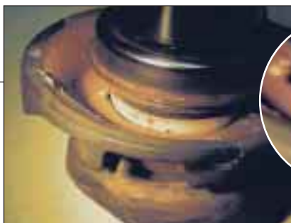
Разрушение керамического кольца в результате термического удара
