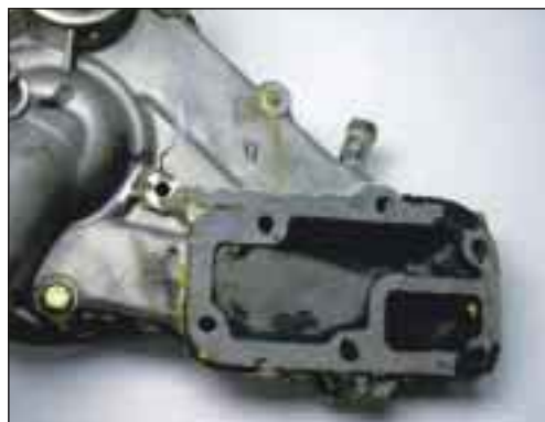
Избыточный уплотняющий материал
