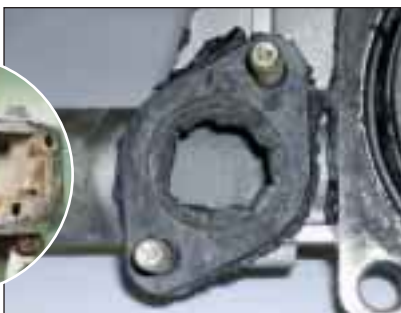
Ржавчина или известковые отложения – отсутствие охлаждающей жидкости
