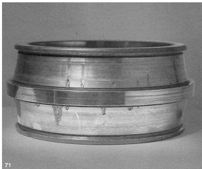
Рис. 71 Усталостные раковины на обеих дорожках качения внутреннего кольца сферического роликоподшипника, развившиеся от повреждений вследствие вибраций
