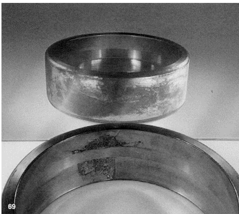
Рис.69 Усталостная раковина на дорожке качения наружного кольца сферического роликоподшипника и соответствующая обширная область контактной коррозии на посадочной поверхности (для фотографирования кольцо положили напротив зеркала). Контактная коррозия посадочной поверхности кольца приводит к увеличению его объема, местным деформациям и перегрузкам. Результатом является усталостное выкрашивание и образование раковин.
