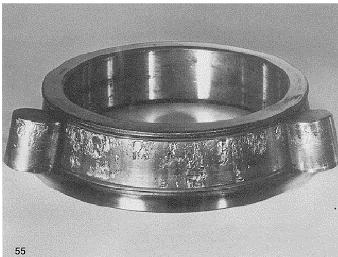
Рис.55 Раковины на внутреннем кольце и роликах конического роликоподшипника. Причинами повреждения были слишком большая нагрузка и недостаточное смазывание
