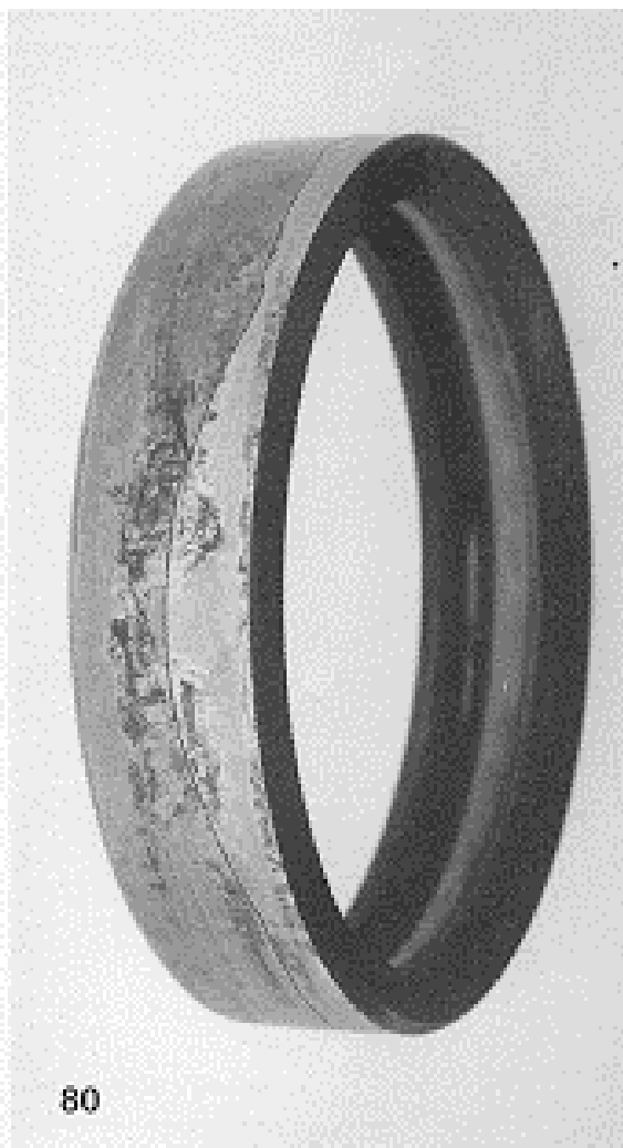
Рис.80 Продольная трещина в наружном кольце радиального шарикоподшипника, обусловленная контактной коррозией. Вследствие увеличения объема в кольце возникают напряжения сжатия.
