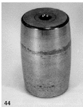
Рис. 44 Разрушение поверхности, распространившееся как полоса по всей окружности ролика сферического роликоподшипника
