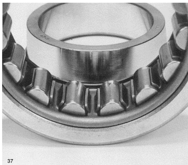
Рис. 37. Цилиндрический роликоподшипник с задирами в виде полосок на дорожке качения внутреннего кольца на расстоянии роликов. Кольца в процессе монтажа были перекошены и не поворачивались друг относительно друга.
