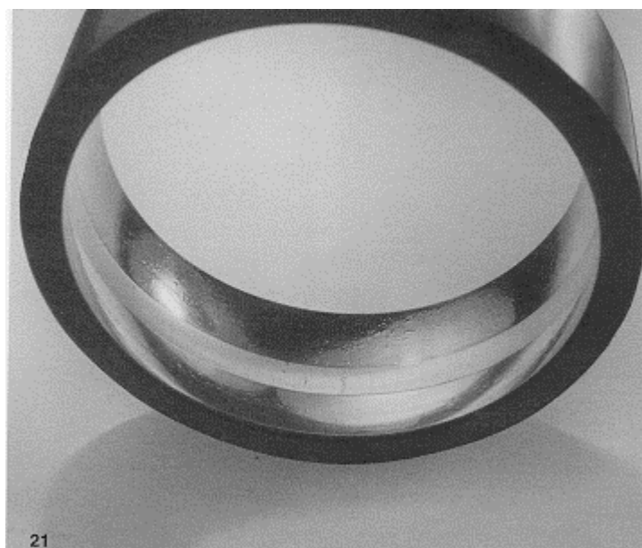
Рис. 21. Наружное кольцо двухрядного сферического роликоподшипника смазывалось недостаточно. Дорожки качения выглядят как отполированные до зеркального блеска.
